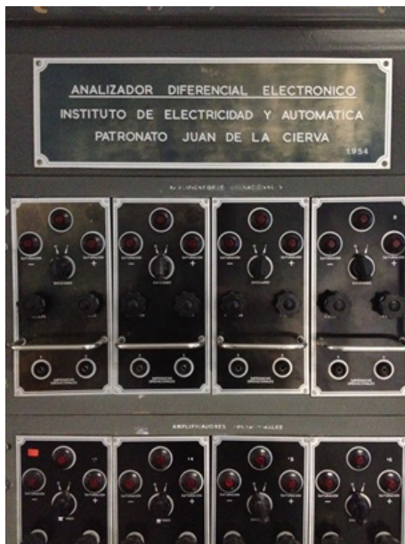
Detalle del Analizador Diferencial Electrónico, primer ordenador fabricado en España y conservado en el Museo de la Informática García Santesmases de la Universidad Complutense de Madrid. Fuente: archivo personal.
