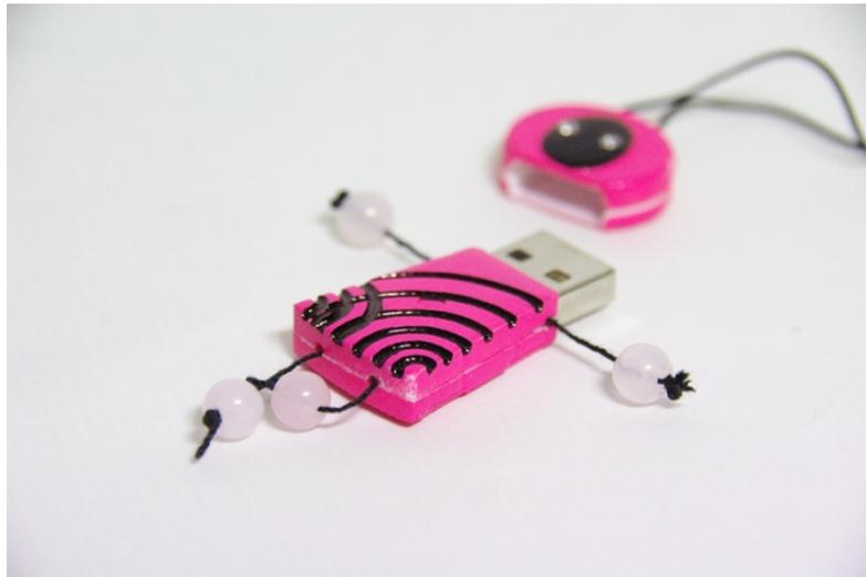
Prototipo realizado en una CNC. Materiales: plástico ABS, caucho y cuerda flexible.
