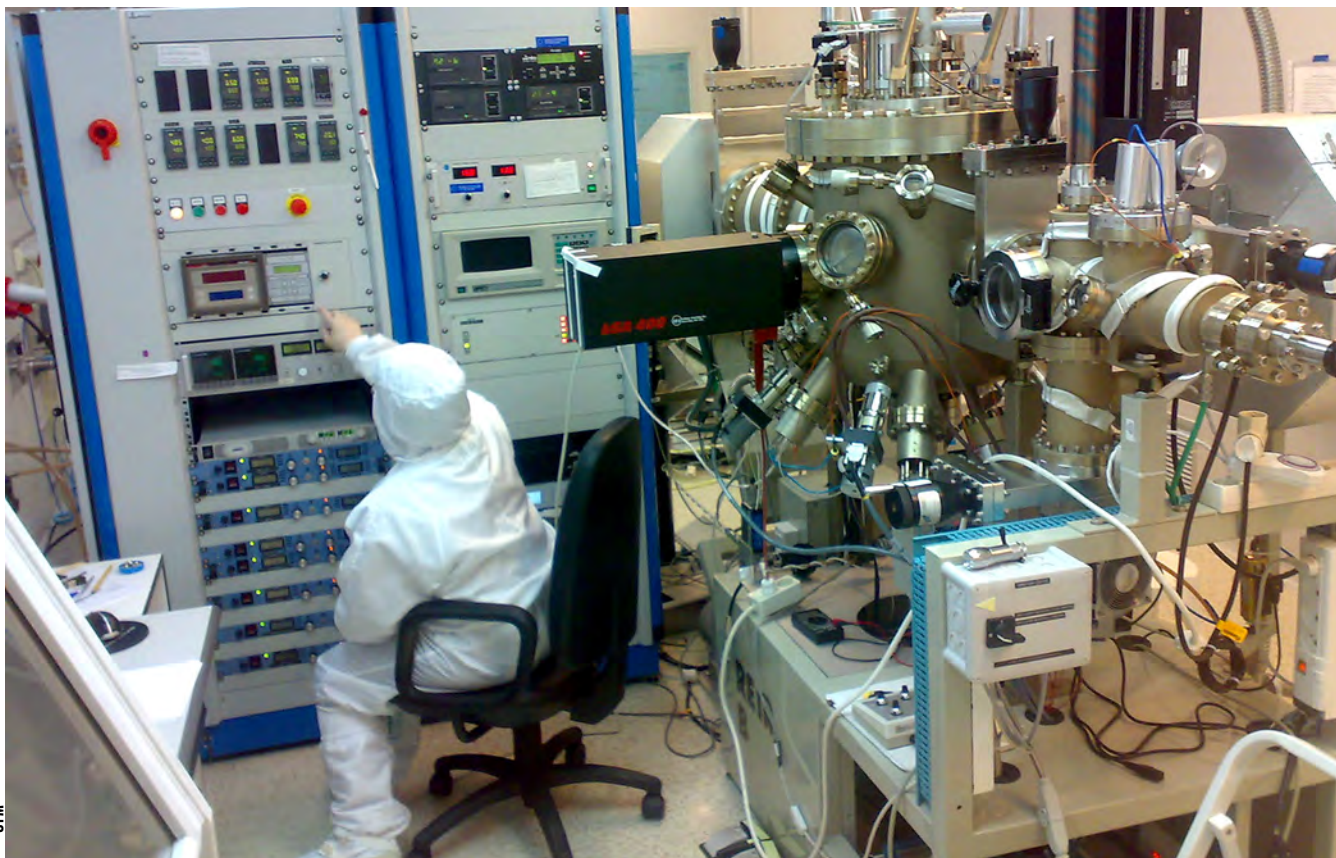
Nuevo MBE-RIBER, instalado en la Universidad Politécnica y parte del clúster de Materiales para el Futuro
