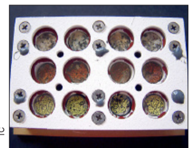
El BIOPAN es el dispositivo rojo y redondo que aparece en el exterior de la Fotón M-2. Encima de estas líneas el kit con los diferentes líquenes que fueron montados en el BIOPAN en las instalaciones holandesas de la ESA a mediados del mes de mayo.
