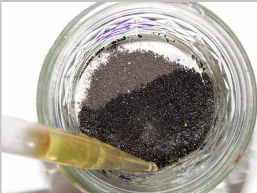
Humectación de agregados destruidos para estudiar cuánto dióxido de carbono liberan
