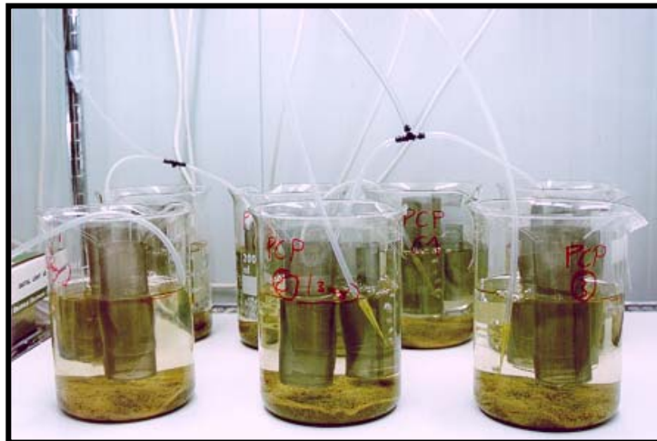
Figura 1: A) Esquema general del sistema multi-especies al inicio y final del ensayo. En un principio se colocaron dos reservorios en cada sistema con el fin de observar efectos agudos por exposición al tóxico únicamente a través del agua superficial. Al final del ensayo podían observarse efectos en la reproducción de D. magna tanto debidos a la exposición a través de agua y sedimento, como los debidos a la exposición a través del agua únicamente (en el caso de las daphnias situadas en el interior del reservorio). Por otro lado al final del ensayo podían observarse efectos en la capacidad de C. prasinus para llegar a la madurez sexual con la fase adulta (mosquito). B) Vista general de todos los sistemas agua-sedimento del ensayo multi-especies.
