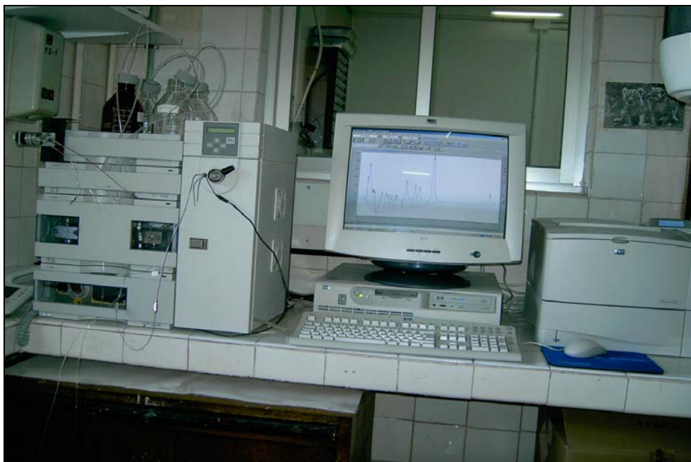
Figura 11. Equipo de cromatografía líquida capilar con detector de matriz de diodos (Agilent Mod. 1100 Series).
