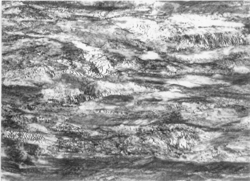
Fotografía 18.- Sección longitudinal del acero ensayado ( X 1000 )
