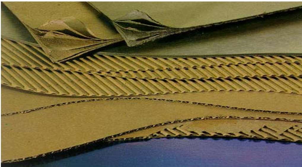
Figura 2.17.- Estructura interna de un cartón corrugado.
