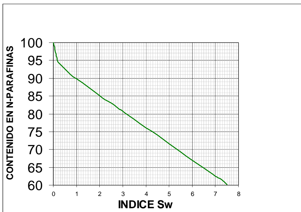
Figura 2.11.- Determinación del contenido de n-parafinas a partir del índice S_w .
