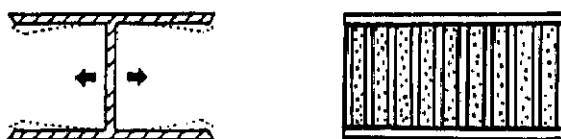
Fig.52. Las vigas en doble "T", punto de partida de los paneles tipo "sandwich".
