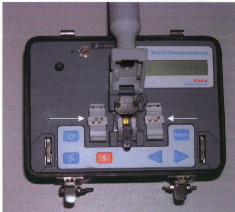
**Figura 5.7** Fusionadora de fibra óptica
