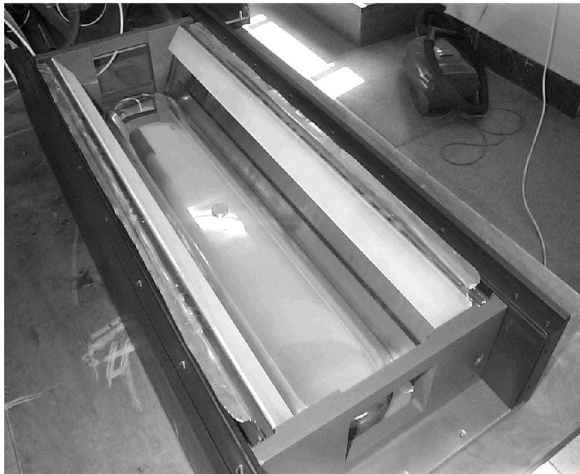
Figura 7.1: Imagen real del resonador del láser TEA-CO<sub>2</sub> en construcción, con los electrodos de alta compactificación.
