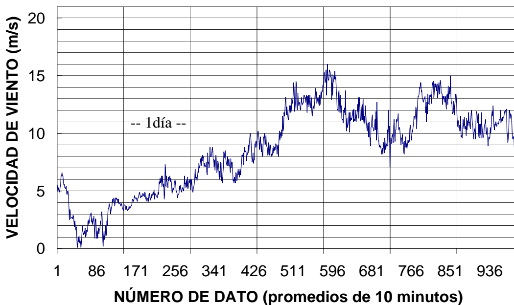
Figura 4.15. Velocidad de viento a 10m de altura, en la Planta Eólica de Tarifa, en una semana con viento de levante.
