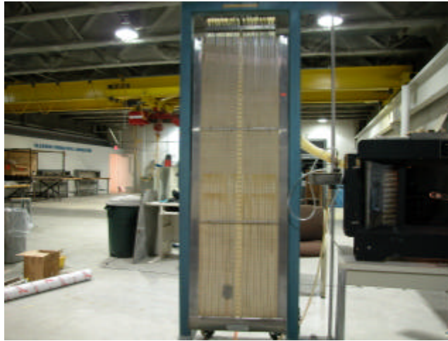
Figura 2.10. Aspecto físico de un manómetro múltiple de agua.
