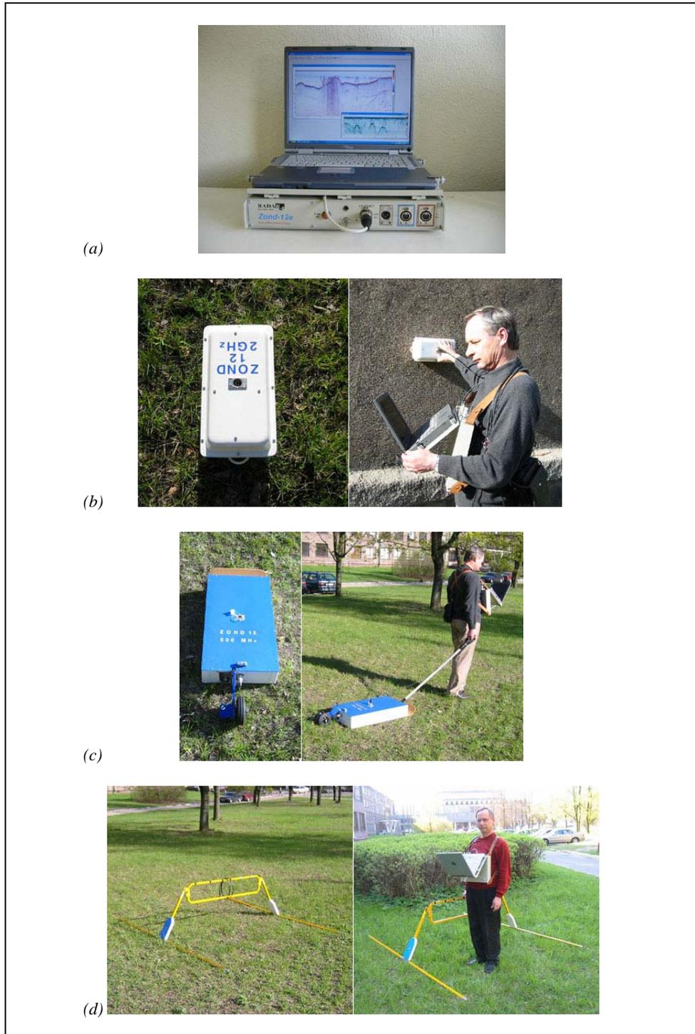
Figura 2-1-1: Elementos de un geo-radar.
