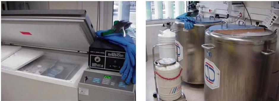
Figura 4 - Alternativas para la conservación de PH. Izquierda: ultracongelador mecánico capaz de mantener temperaturas por debajo de  $-120^{\circ}\text{C}$ . Derecha: tanques de nitrógeno líquido, que mantienen  $-196^{\circ}\text{C}$  en la fase líquida y entre  $-140^{\circ}\text{C}$  y  $-196^{\circ}\text{C}$  en la fase de gas.
