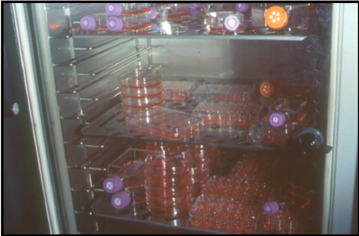
FIGURA 6: Estufa empleada para la incubación a 37^{\circ} C en atmósfera húmeda de 95% de aire y 5% de CO_2 .
