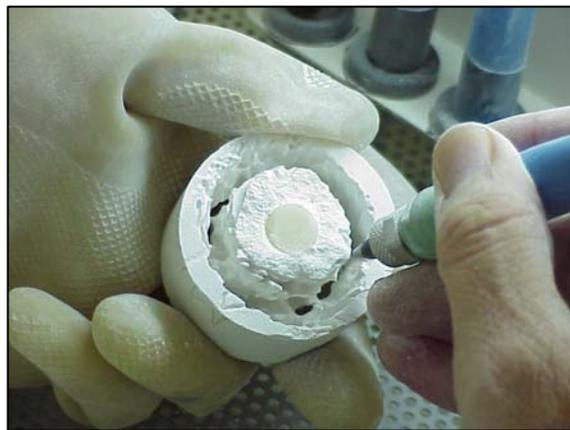
**Fig. 24.** Retirado del revestimiento enfriado.
