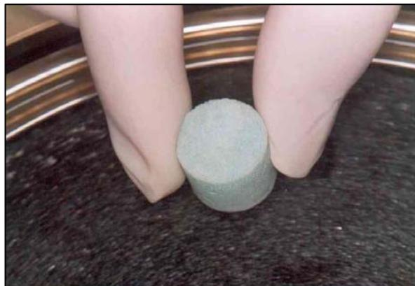
**Fig.20.** Preparación de las muestras en la pulidora.
