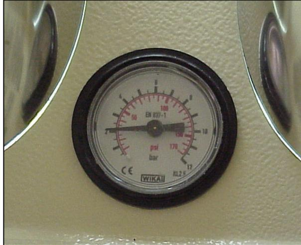
**Fig.26.** Presión utilizada para el arenado de los discos de cerámica.
