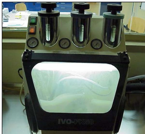
**Fig 27.** Máquina IVO-FK50, para realizar el arenado de cerámica.
