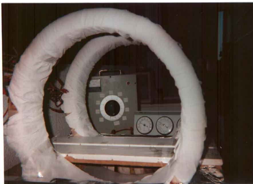
Figura 1. Cámara de campos magnéticos de 50 Hz.
