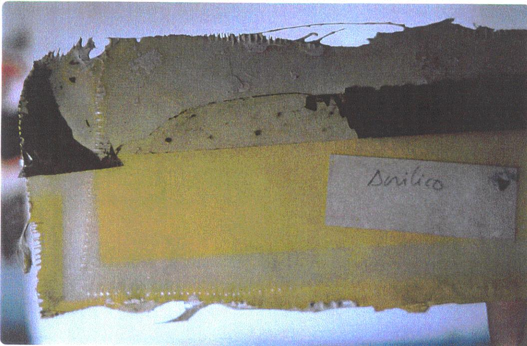
**Figura III.18** Parte de atrás de una muestra donde se ve claramente el amarilleo del soporte.
