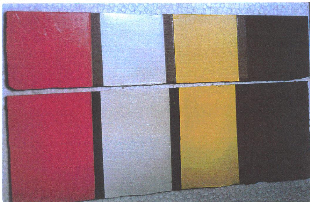
**Figura III.13** Muestras sobre diferentes laminados (resina fenólica y epoxy) utilizadas para el ensayo de diferencias de color, después del proceso de envejecimiento.
