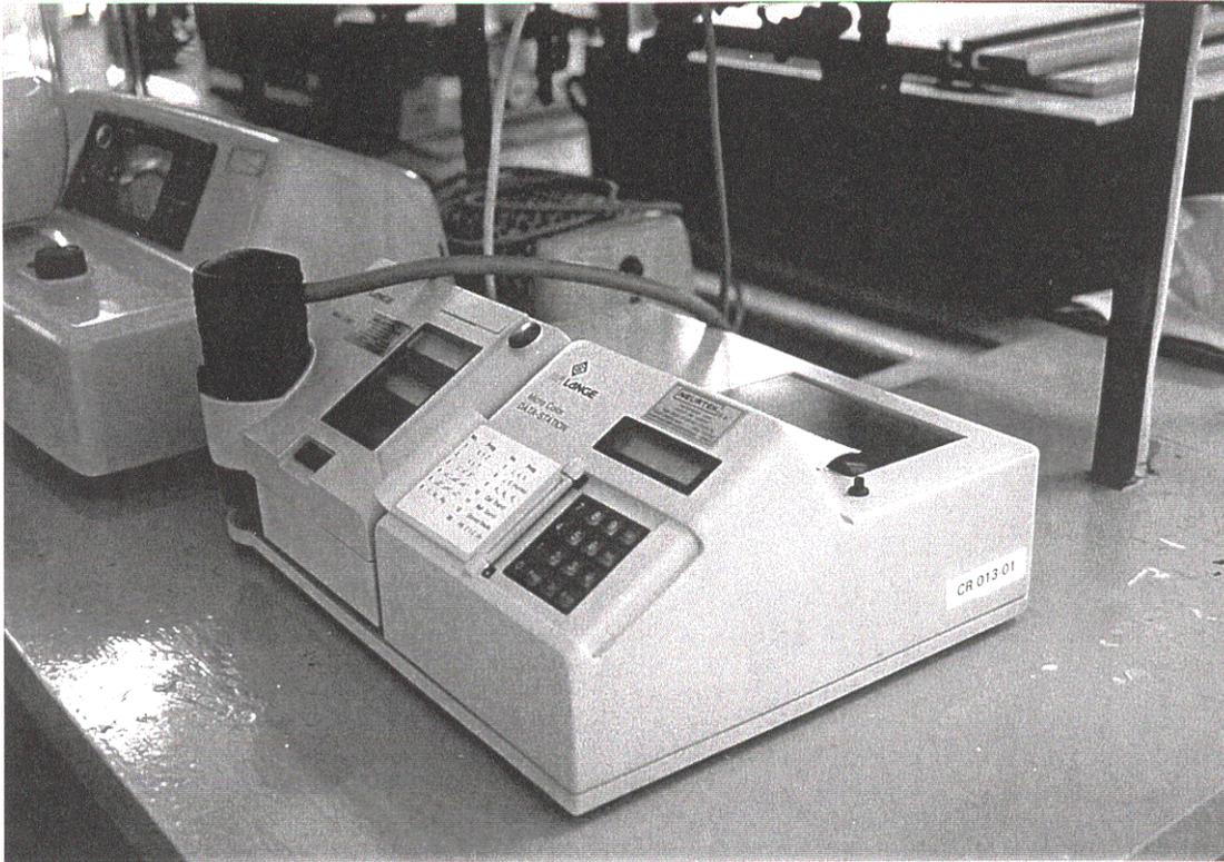
**Figura III.3** Colorímetro del Dr. Lange usado durante los ensayos.
