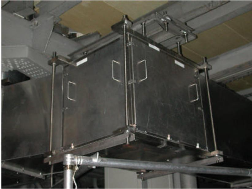
Con las paredes metálicas cubriendo la línea surge otro problema. Si la densidad del plasma es muy alta y se alcanza la densidad de corte, las microondas son reflejadas y pueden llegar hasta el girotrón, afectando su estabilidad. Para evitarlo es conveniente cubrir las láminas metálicas (de aluminio en el caso de las líneas del TJ-II) con un material absorbente.
