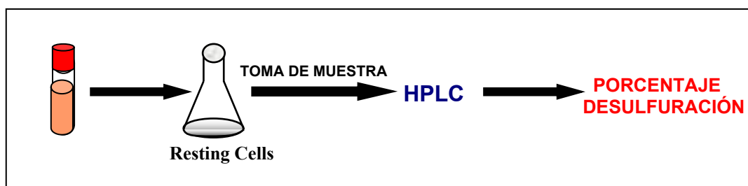
Figura 2.6. Esquema del procedimiento experimental para el análisis de la capacidad de desulfuración.
