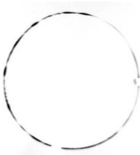
Figura 4.2: Imagen de la circunferencia obtenida con un hilo con defectos longitudinales. Aparecen una serie de máximos y mínimos de intensidad que están relacionados con los defectos. El máximo de difracción ha sido eliminado para evitar la saturación de la cámara.
