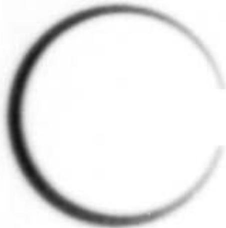
Figura 4.4: Imagen de la circunferencia obtenida con un hilo con una superficie rugosa. El ensanchamiento es máximo para un ángulo de  $180^\circ$  del ángulo de incidencia. El máximo de difracción ha sido eliminado para evitar la saturación de la cámara.
