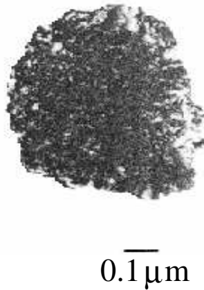
Figura 9.12: Micrografía de microscopio electrónico de transmisión de un cristal en una película delgada de Si, calentada a 608° C durante 17 horas. Tomado de la referencia [117].
