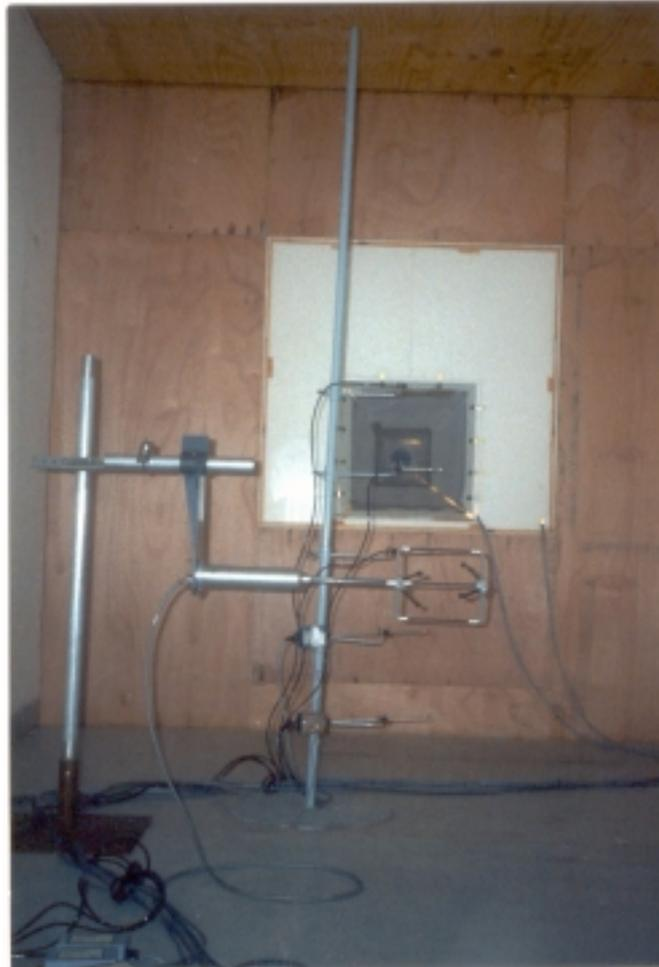
**Figura (3.15).** Imagen del conjunto de instrumentos instalados sobre la varilla para la malla B. Obsérvese como el anemómetro sónico se encuentra en una posición horizontal para poder medir cerca del suelo.
