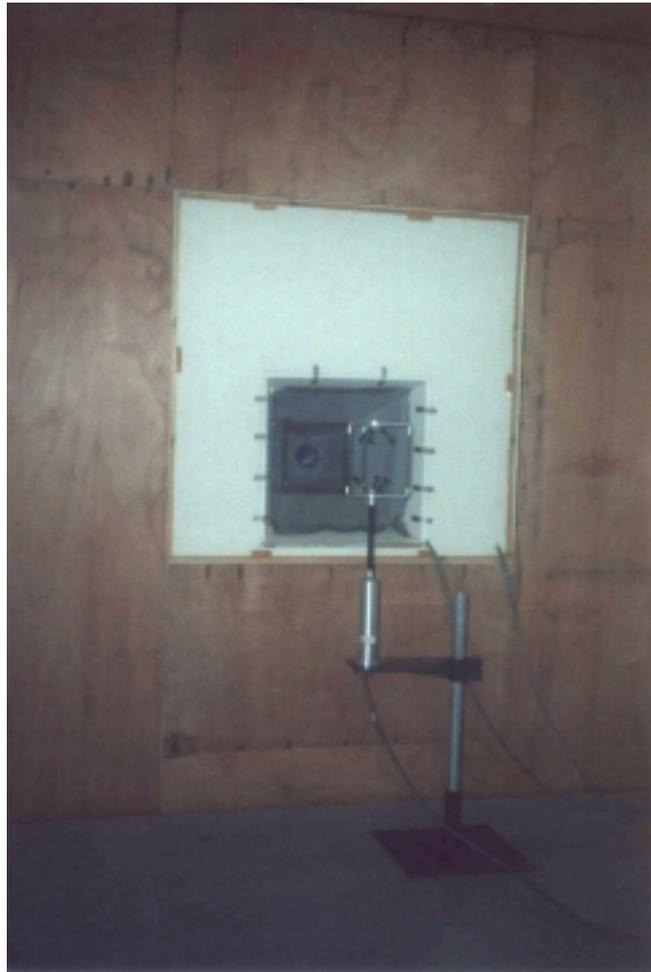
**Figura (3.6).** Disposición del anemómetro sónico (AS) sobre su base cilíndrica en una posición cercana a la ventana.
