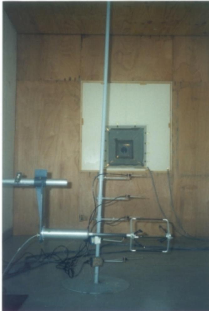
**Figura (3.18).** Imagen de los anemómetros de hilo caliente (AHC) y termopares (TP) sobre la varilla para las posiciones de la malla C, así como, la posición del anemómetro sónico (AS) en dicha malla que es la que mide más próxima al suelo.
