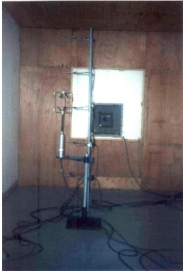
**Figura (3.11).** Imagen de los anemómetros de hilo caliente (AHC) y termopares (TP) sobre la varilla en la malla A, así como, la posición del anemómetro sónico (AS) en dicha malla.
