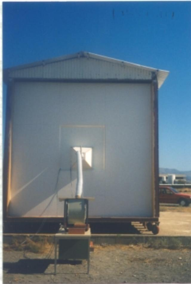
**Figura (3.5).** Fachada sur de la Célula, donde se observa el tronco de pirámide mediante el cual fue introducido el flujo de aire en el interior de la misma.
