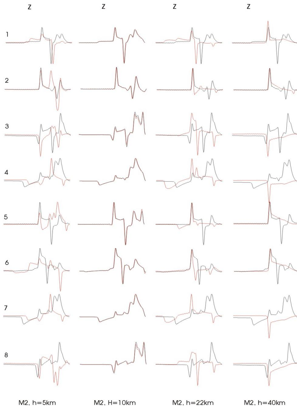
**Fig. 4.12** Componentes verticales de los desplazamientos observados (negro) y teóricos (rojo) para las soluciones de los test LL2, LL4, LL6 y LL8 (de la izquierda a la derecha). Cada línea se refiere a una estación.
