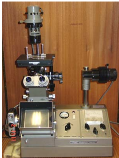
Figura 11. Microscopio metalográfico, y ejemplo de probeta.
