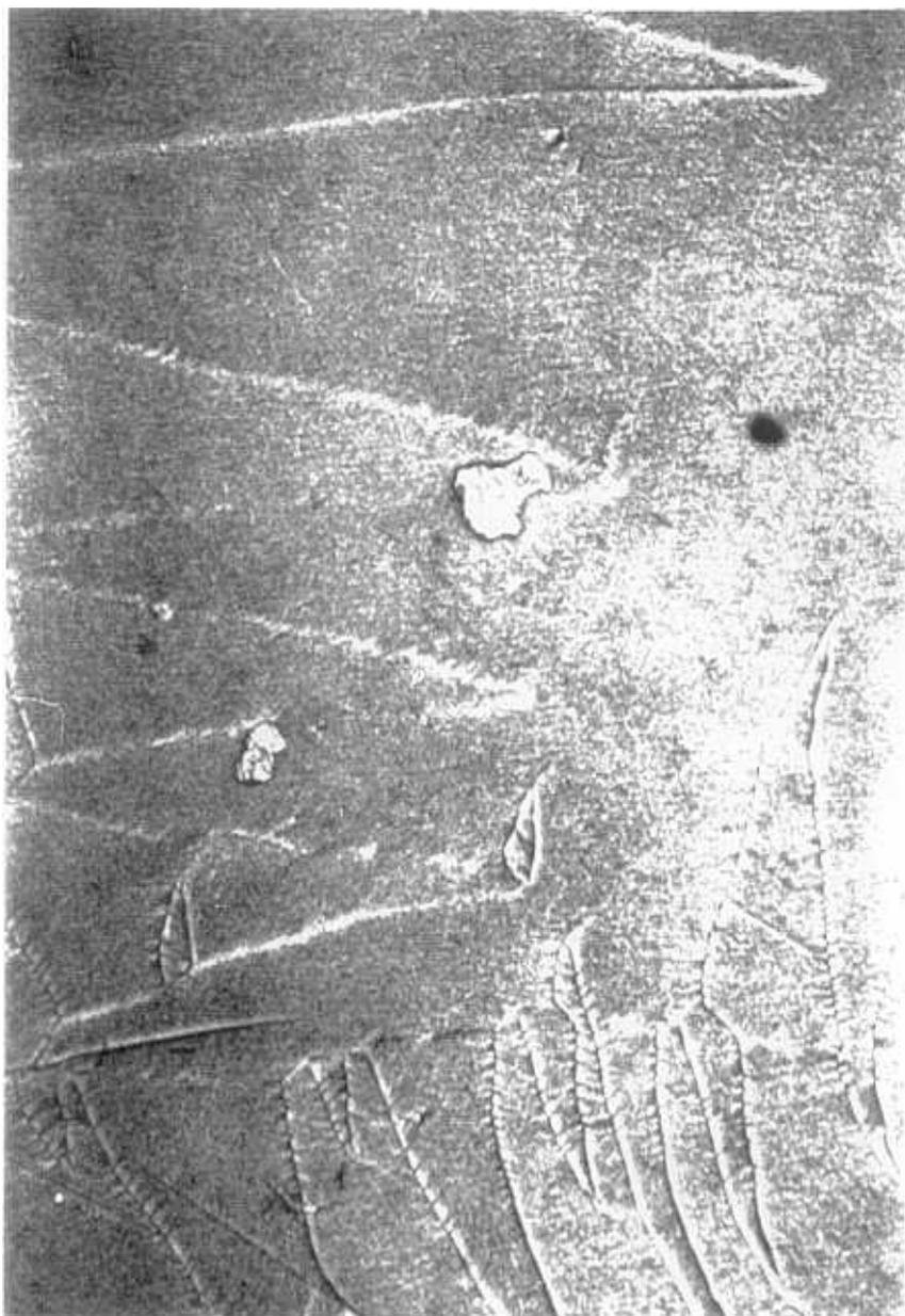
**Figura 6.16** Estructura de dominios en una región en la que las paredes de ambas capas se superponen. En aquellas zonas próximas al vértice en las que las paredes se cruzan las paredes de una capa “cortan” a las paredes de la otra dando lugar a algunos dominios en forma de “isla”.
