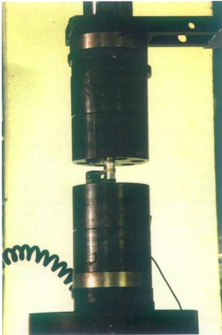
Figura 4.27: Dispositivo utilizado para realizar los ensayos de deformación cíclica.
