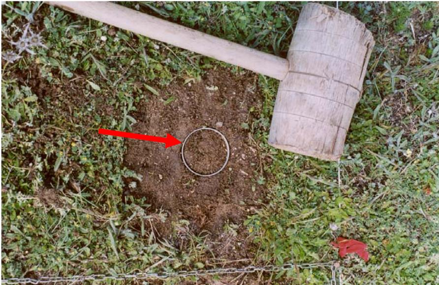
**Figura 4.2.** Foto de la sonda utilizada para el cálculo de la humedad, porosidad y aireación del suelo.
