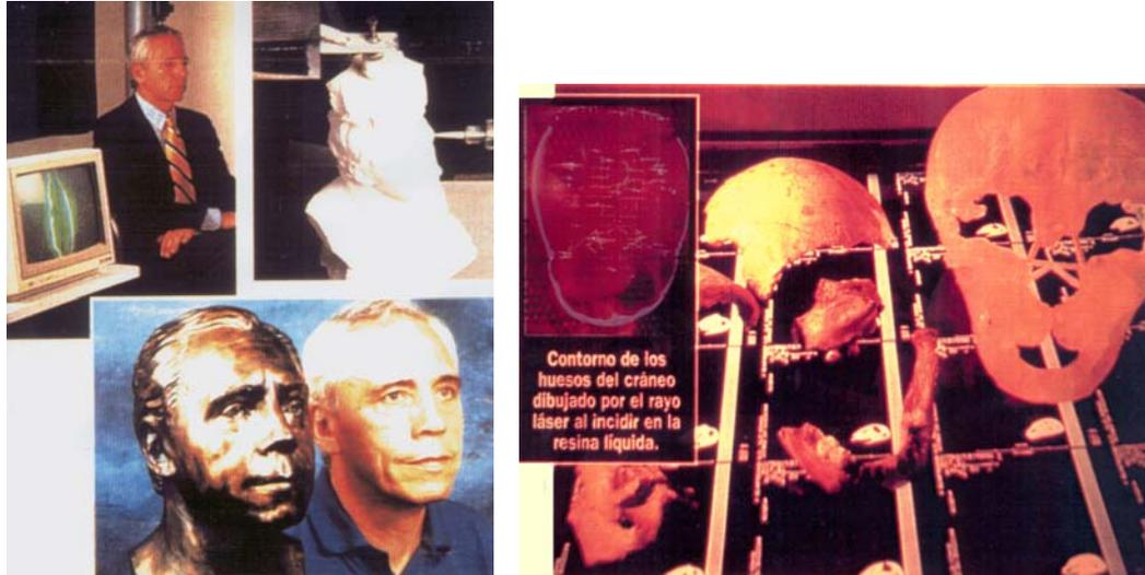
Nuevos métodos de reproducción en tres dimensiones. El primero hace una lectura, mediante escáner, del objeto a reproducir. El procesado informático de los datos permite a la herramienta de desbaste la obtención de un modelo con el que construir un molde. El segundo realiza una lectura semejante para, mediante un rayo láser ultravioleta, polimerizar la resina contenida en una cubeta. De este modo se obtiene una fiel reproducción (en este caso de los huesos de un cráneo).
