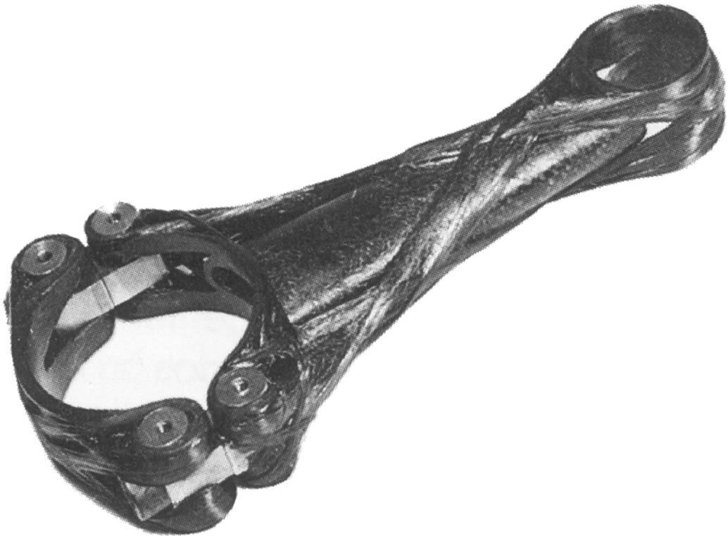
Biela de material compuesto con fibras orientadas. Obsérvese la organicidad de la forma (Ezio Manzini, *La materia de la invención*)
