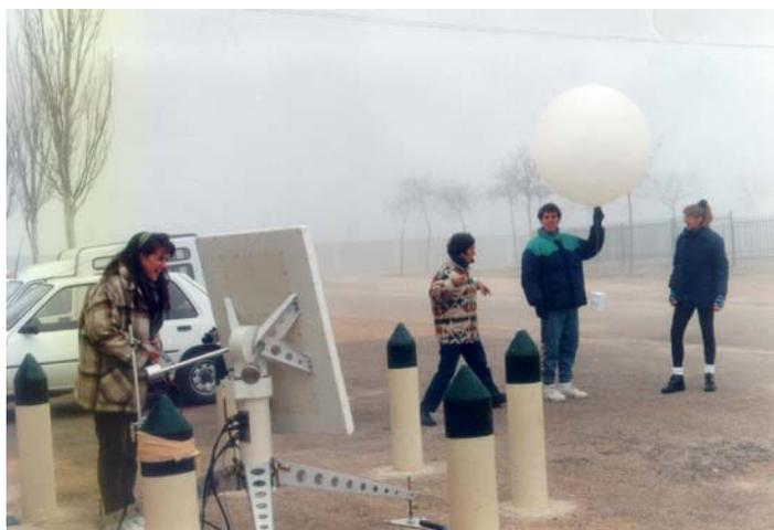
Foto 2. Sincronización de la señal de la sonda libre con el radioteodolito.
