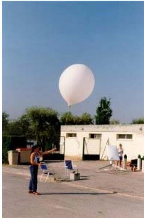
*Fig. 3.5a. Lanzamiento de un globo-sonda libre.*
