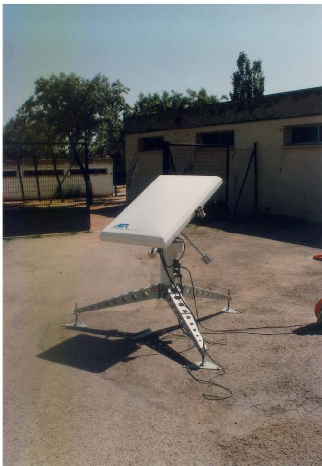
*Fig 3.4. Imagen del radioteodolito del sistema de sondeos con globo libre.*
