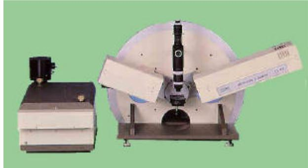
**Figura 1.** Elipsómetro espectroscópico ES-4G de SOPRA.
