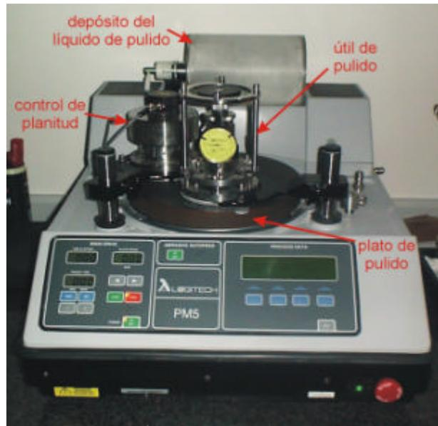
**Figura 9.** Pulidora automática Logitech PM5
