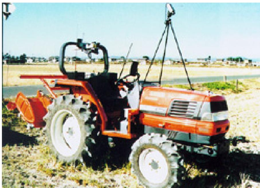
**Figura 2.11 :** Tractor controlado remotamente para distintas labores agrícolas [BRAIN, 2002]
