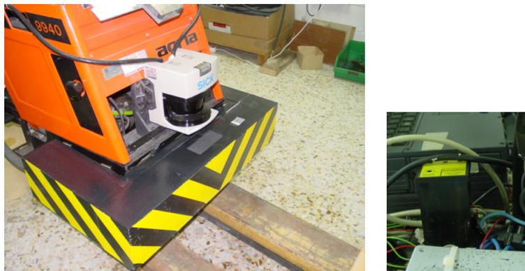
Figura 4.21 : Sensor para detección de colisión y unidad de control.
