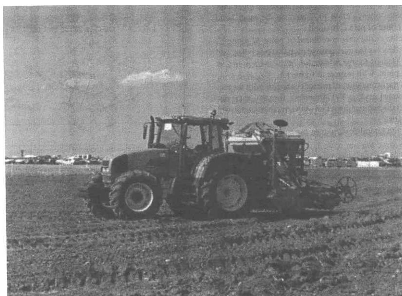
**Figura 2.15 :** Tractor con sistema de guiado basado en CP-DGPS [Thuilot et al., 2002]
