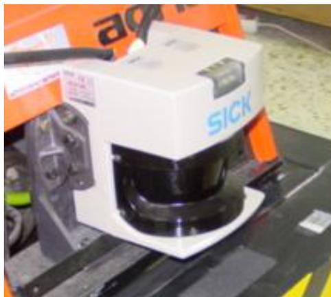
**Figura 4.22 :** Láser de barrido SICK modelo LMS291
