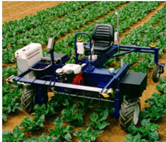
**Figura 2.18** : Robot para tratamientos de hortalizas: Silsoe Research Institute [Hague et al., 1999b]
