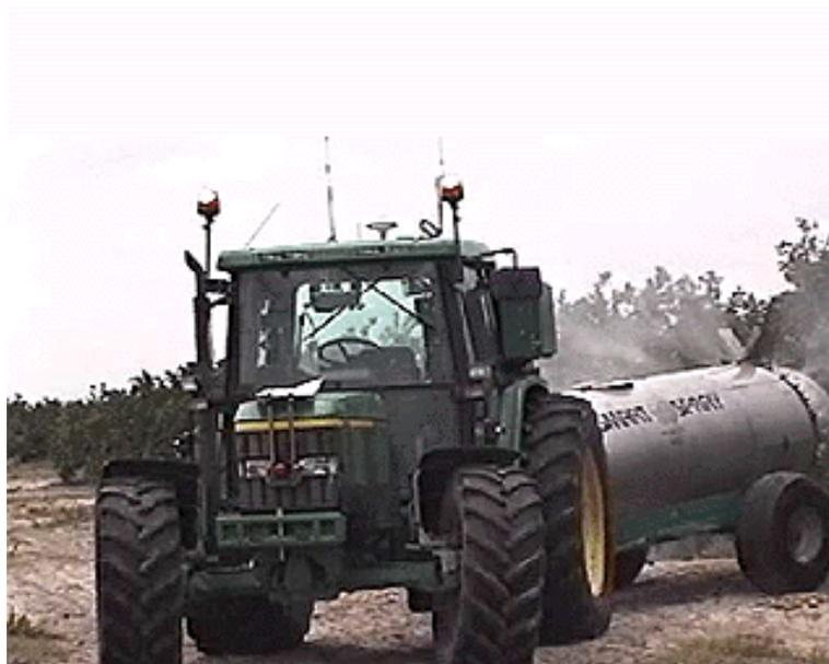
**Figura 2.23 :** Tractor semi-autónomo para plantaciones de cítricos [Stentz et al., 2002]
