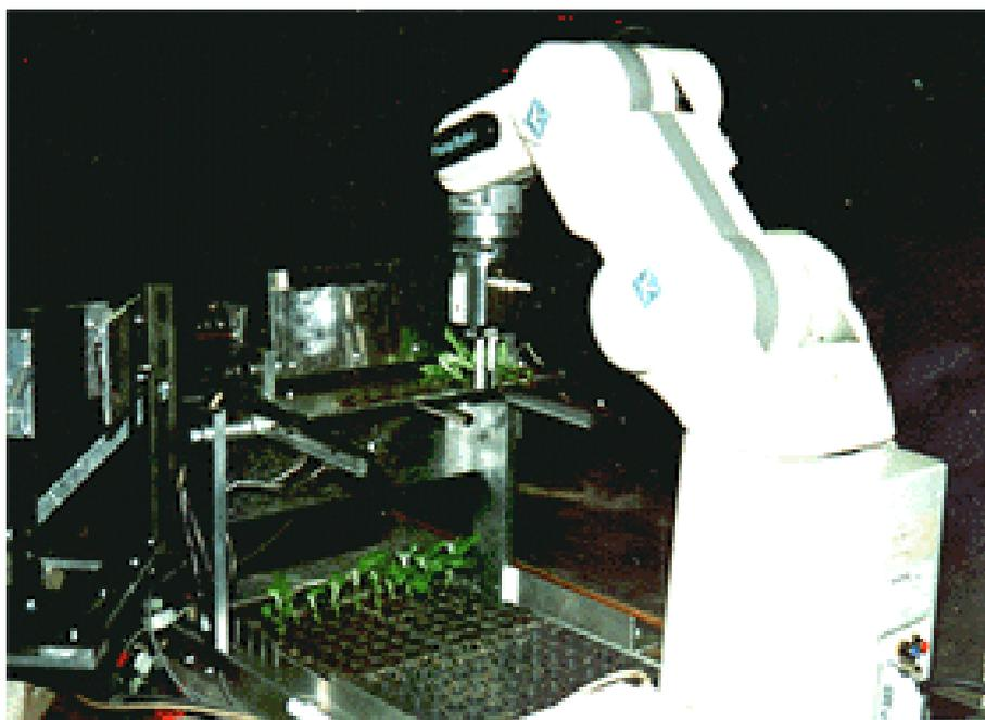
**Figura 2.1** : Robot para la recogida y preparación de crisantemos [LASE, 2002a]
