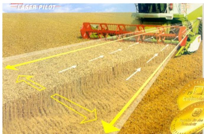
**Figura 2.17 :** Sistema comercial de guiado: AutoPilot de Claas
