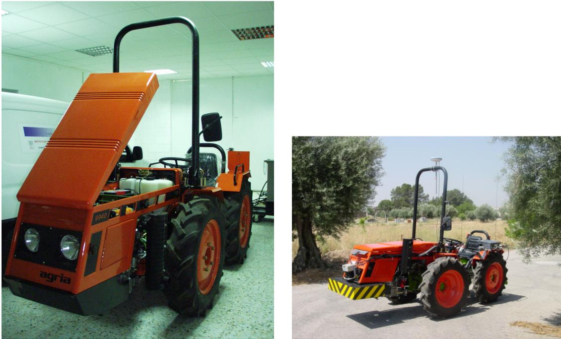
**Figura 4.10 :** Tractor Agria Hispania 9900 (al llegar de fabrica) y robot DÉDALO (en la actualidad)
