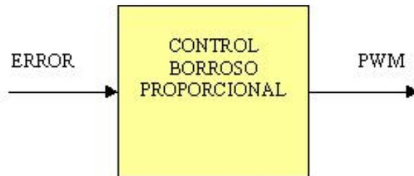
**Figura 4.28 :** Esquema del controlador proporcional de la dirección
