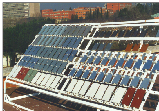
Figura 17. Vista de las estaciones de corrosión atmosférica de Avilés y Madrid.
