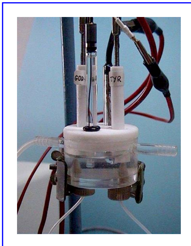
Figura 18. Esquema de la célula de flujo tipo "wall-jet" para dos electrodos indicadores investigada.
