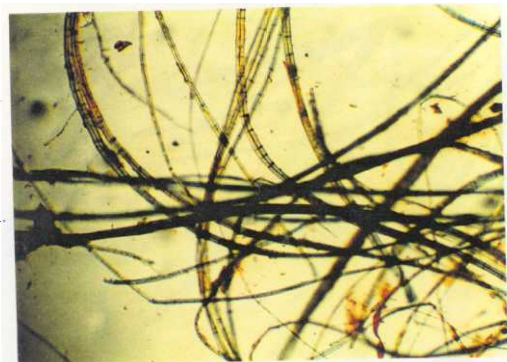
FIBRAS DE LINO DE LOS HILOS DE URDIMBRE: Aspecto longitudinal
