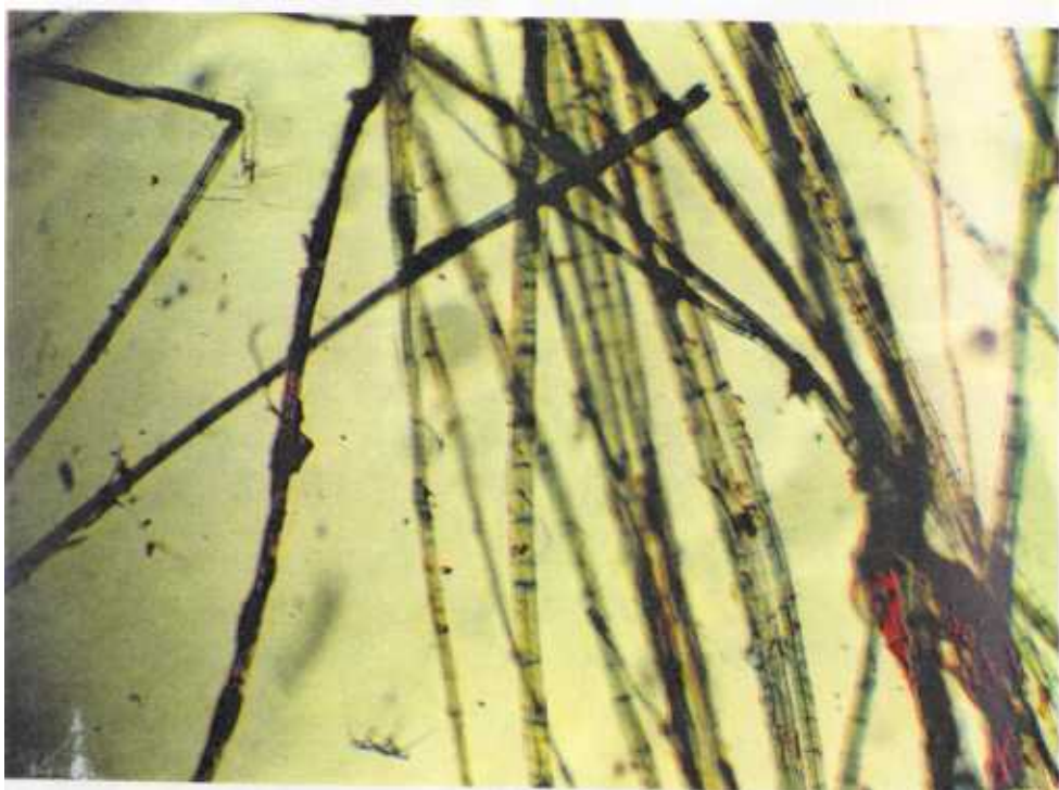
FIBRAS DE LINO DE LOS HILOS DE TRAMA
