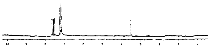
Figura 29.- Espectro de RMN- ^1\text{H} del complejo [\text{Rh}(\text{S}_2\text{COMe})(\text{CO})(\text{P}(4\text{-FC}_6\text{H}_4)_3)] .
