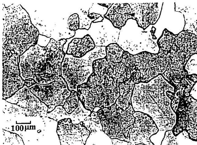
Figura 11.- Microestructura completamente ferrítica. Acero Armco.
