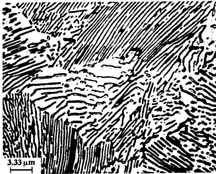
Figura 1.- Perlita laminar formada isotérmicamente a 978 K en un acero eutectoide (30).
