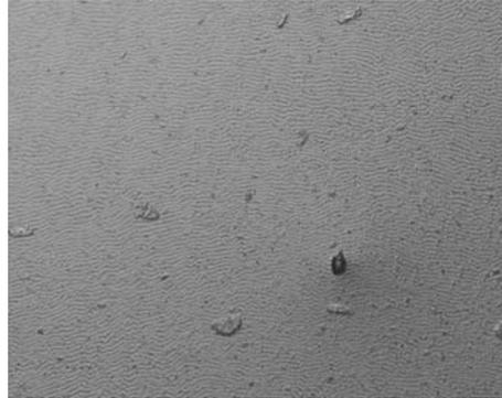
**Figura 4.9.** Estructura de dominios de una monocapa de Co-P. La presencia de dominios tipo *stripe* es característica de la presencia de una fuerte anisotropía perpendicular en la muestra.
