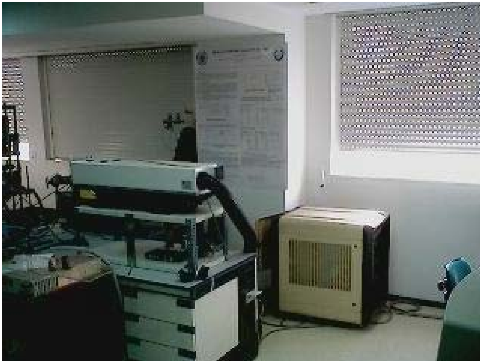
Fig 2.5 LÁSER DE ESTADO SÓLIDO Y DEL TIPO Nd:YAG PULSADO (Q-SWITCH) FABRICADO POR LA EMPRESA QUANTEL -MODELO YG 585-.
