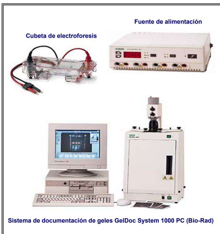
**Figura 25.** Electroforesis en gel de agarosa y visualización de los fragmentos de ADN.
