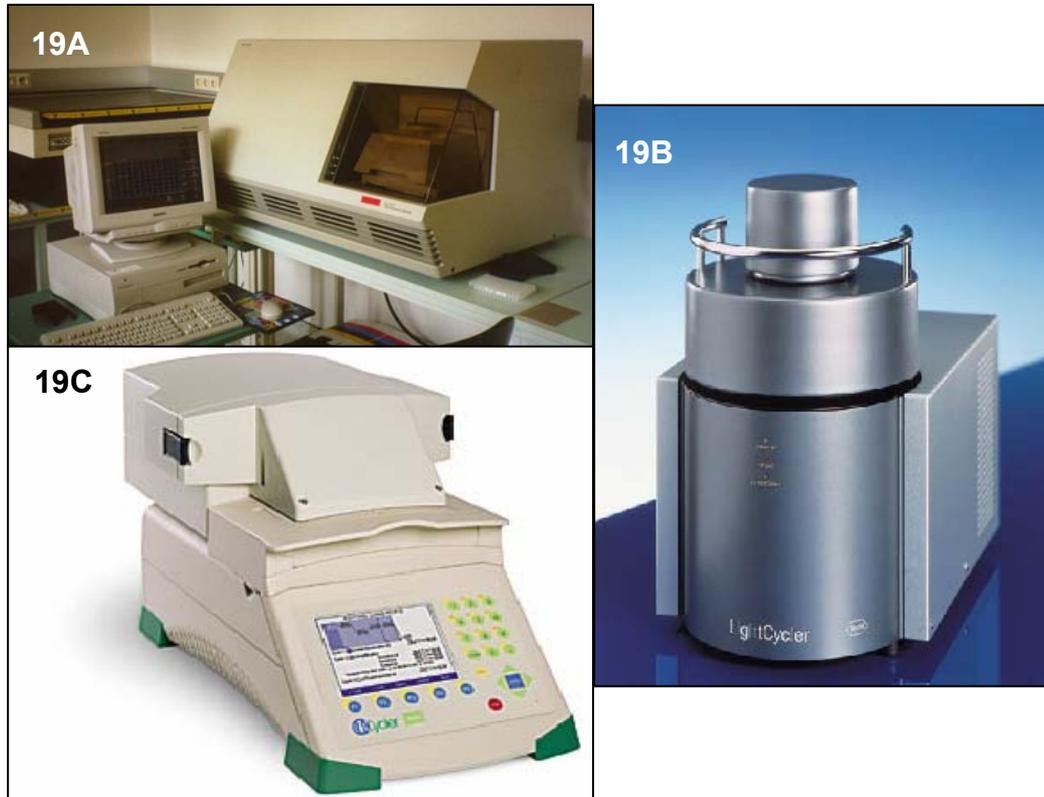
**Figura 19.** Equipos empleados en la cuantificación en tiempo real. **19A)** SDS 7700 de Applied Biosystems; **19B)** Sistema *Lightcycler* de Roche; **19C)** Sistema de detección de PCR en tiempo real de Bio-Rad.
