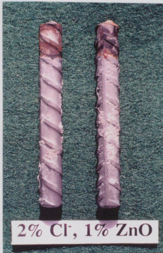
*Fig. 62.- Aspecto de los redondos embebidos en un mortero con 2%Cl<sup>-</sup> + 1% ZnO al término del ensayo. El ZnO ha eliminado la corrosión en las superficies libres, pero no en las ocluidas bajo la resina epoxi, que pretendía enmascarar la soldadura con el alambre de cobre.*
