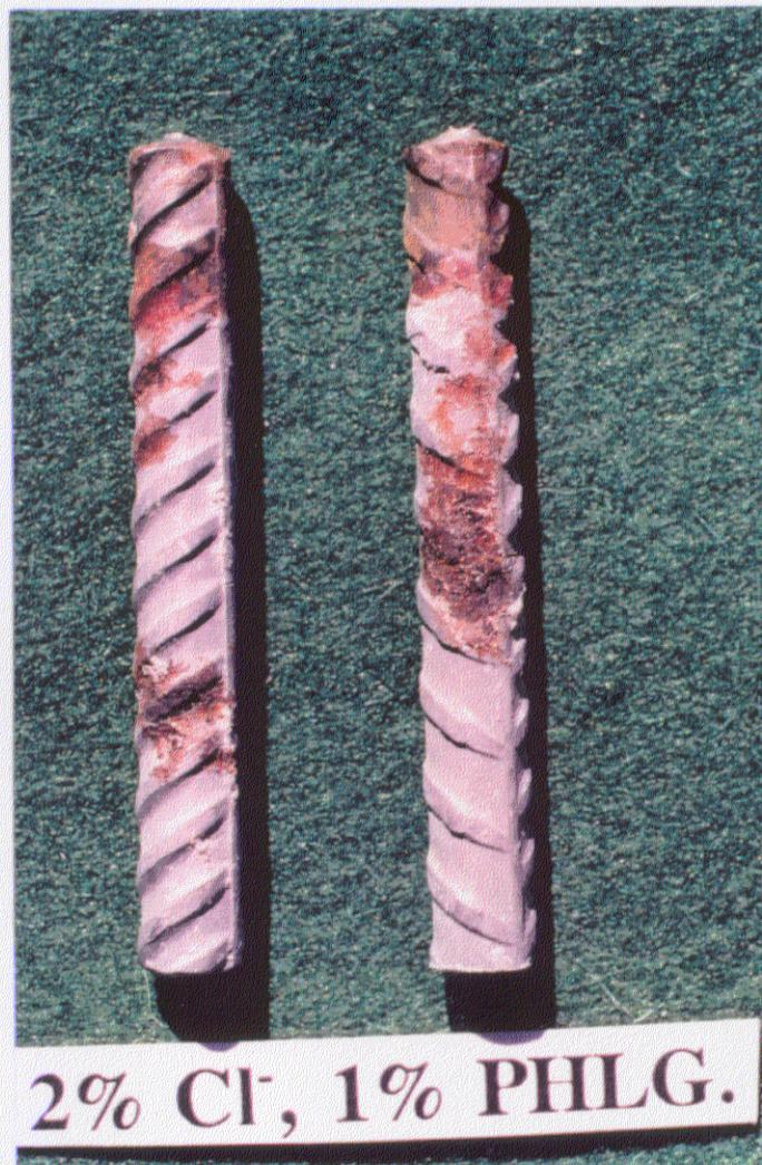
*Fig. 61.- Aspecto de los redondos embebidos en un mortero con 2%Cl<sup>-</sup> + 1% fluoroglucinol al término del ensayo.*
