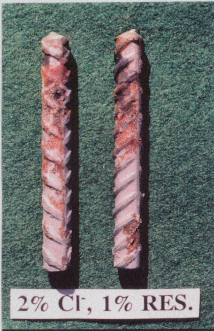
*Fig. 60.- Aspecto de los redondos embebidos en un mortero con 2% de Cl<sup>-</sup> + 1% resorcinol al término del ensayo. Es evidente la pérdida del estado pasivo.*
