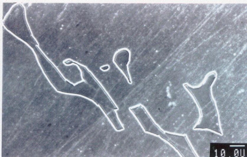
Figura 129: Microestructura del acero AISI 304L fundido, en estado de solubilización.
