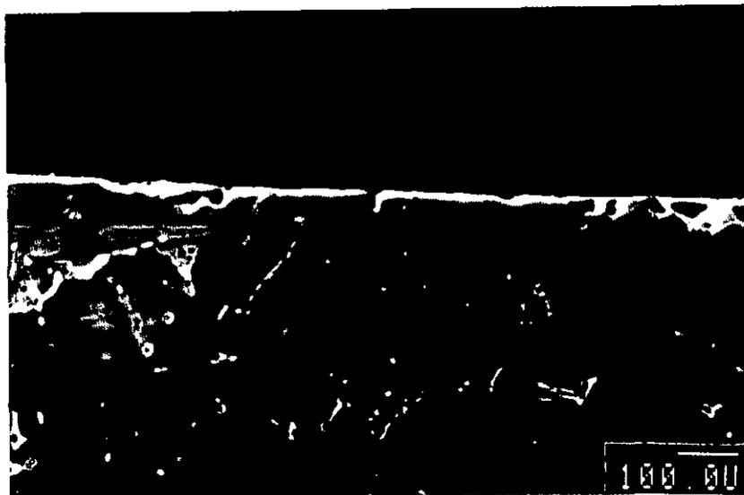
Figura 145: Acero AISI 304L fundido, tratado a 973 K durante 6 000 min, sometido al ensayo Huey, corte transversal.
