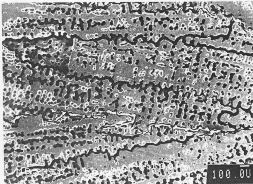
Figura 146: Acero AISI 316L fundido, tratado a 973 K durante 6 000 min, sometido al ensayo Huey ( $V_{corr} = 0,0298$  cm/mes).
