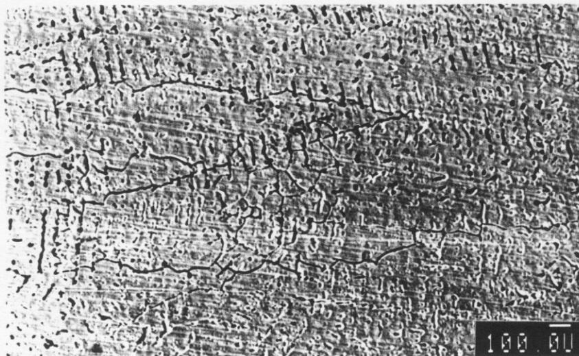
Figura 143: Acero AISI 304L fundido, tratado a 973 K durante 6 000 min, sometido al ensayo Huey. No sensibilizado ( $V_{\text{corr}} = 0,0024$  cm/mes).
