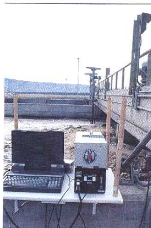
FIGURA 57. Detalle del terminal sensible y del montaje experimental utilizado en las medidas con el sensor de fibra óptica en la balsa de tratamiento biológico de una depuradora.
