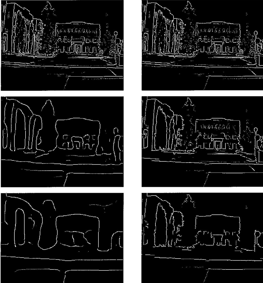
**Figura 3.5.** Comparación de la implementación usual del filtro de Canny (columna izquierda) y la implementación multirresolución propuesta (columna derecha), para anchuras de gaussiana,  $\sigma$ , (de arriba abajo) de 0.5, 5.0 y 10.0 píxeles.
