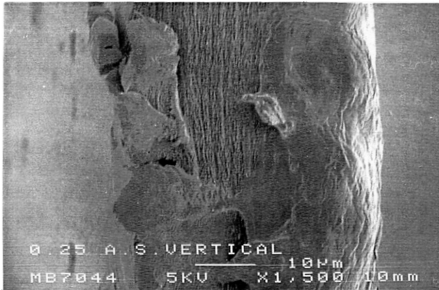
Figura 3.24 Membrana tipo II con 0,25% de ácido salicílico, colocada verticalmente, vista por microscopia electrónica de barrido (5 kV x 1.500 aumentos)
