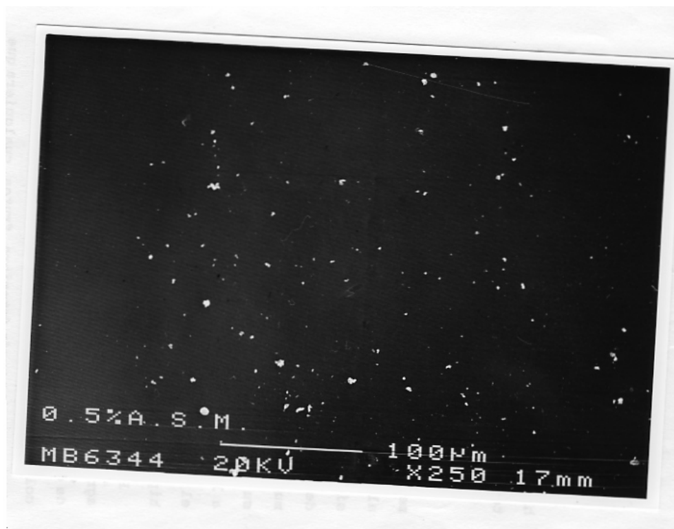
Figura 3.20 Membrana tipo II que contiene 0.50% de ácido salicílico, vista por microscopia electrónica de barrido (20 kVx250 aumentos)
