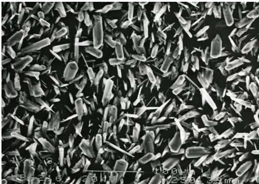
Figura 3.22 Membrana tipo II que contiene 1.00% de ácido salicílico, vista por microscopia electrónica de barrido (20 kVx250 aumentos)
