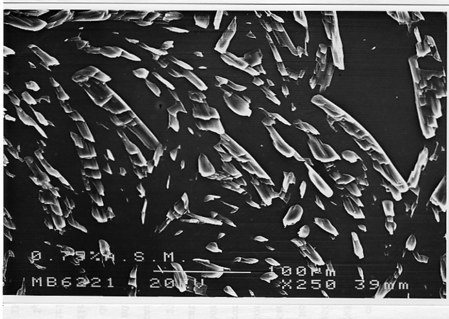
Figura 3.21 Membrana tipo II que contiene 0,75% de ácido salicílico, vista por microscopia electrónica de barrido (20 kVx250 aumentos)
