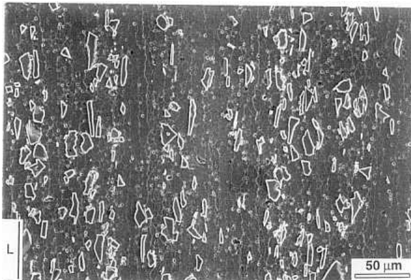
Figura 3.4: Distribución de las partículas de refuerzo en el material compuesto. La micrografía se realizó en contraste de electrones secundarios sobre una superficie pulida y ligeramente atacada en la condición T651.
