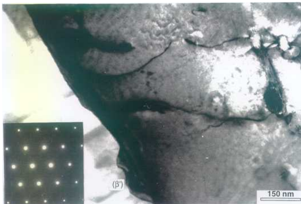
Figura 3.15: Material compuesto en la condición T4 . Campo claro y diagrama de difracción correspondiente. Las reflexiones propias de la estructura L1 2 , característica de la fase \delta' , han desaparecido.
