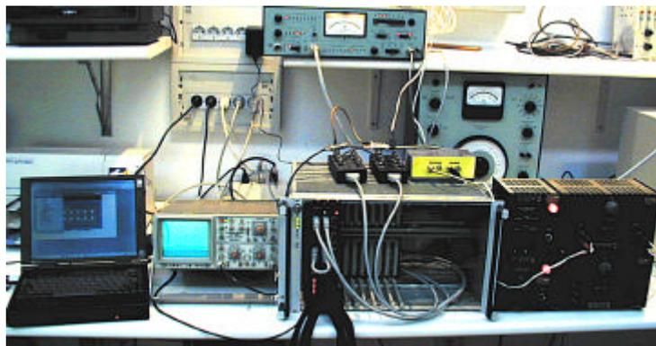
Fig.VI.35. Controlador y otra instrumentación utilizada en los ensayos CAR y CAEE
