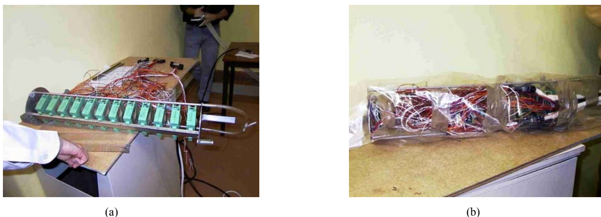
Fig. 3.8 a-b: Las placas han sido colocadas en el carril de sujeción (a) y se han colocado los dosímetros en la parte externa. A continuación, todo el material se empaqueta, y se adosa la cámara de ionización (b). La bolsa de plástico es temporal pues se utiliza para comprobar el buen funcionamiento de la ventilación [Fra05].
